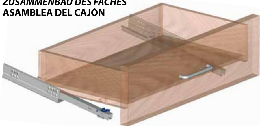
FERMO POSTERIORE DEL CASSETTO POSTERIOR DETENTION OF THE DRAWER ARRÊT POSTÉRIEUR DU TIROIR HINTERE VERZÖGERUNG DES FACHES DETENCIÓN POSTERIOR DEL CAJÓN
